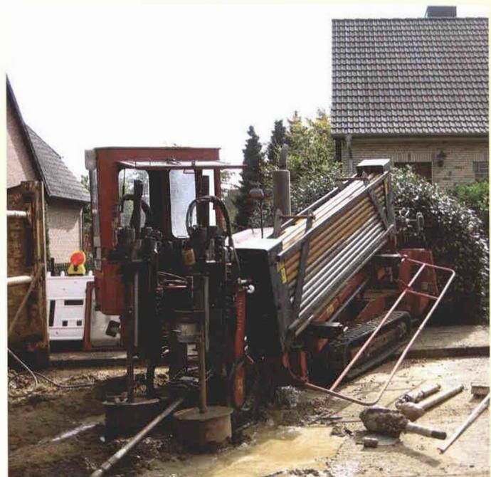
Bohranlage Modell Ditch Witch JT 2720 im Einsatz
