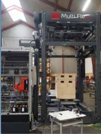
Test und Softwareoptimierung einer Verpackungsanlage bei der Firma Lachenmeier.
