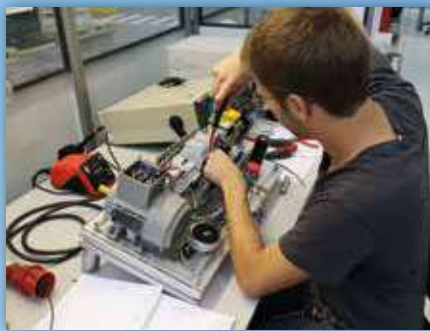
Aufbau einer Stern-Dreieck-Wende-Schützschaltung bei Danfoss.
